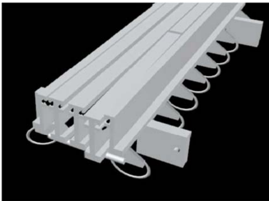
图6 模数式伸缩缝模拟开裂。
