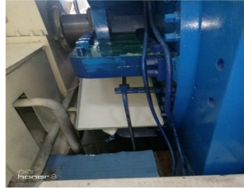
图1 汽端漏油情况。
