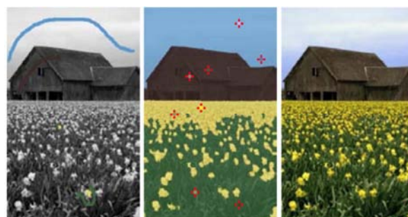
图5 用户在灰度图上添加彩色线条，算法根据线条进行分割，初步上色，最后通过最优算法得出彩色化图像[3]。
