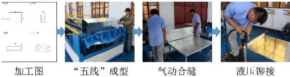
图3 标准风管加工流程。
