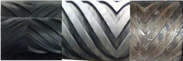
a. 复合胶棍 b. 高密度橡胶棍 c.钢板焊接压扁辊
