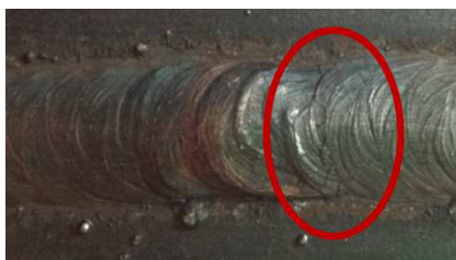
(d) branching cracks
