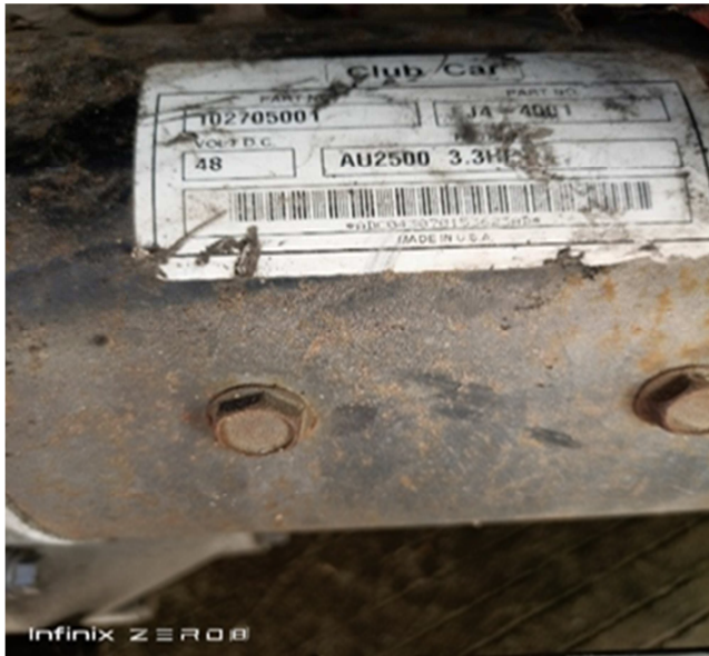
Figure 2. DC motor 3.3 HP 48 Volt.
