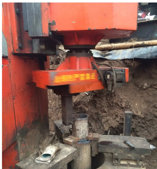
图3 立式车床车扣。
