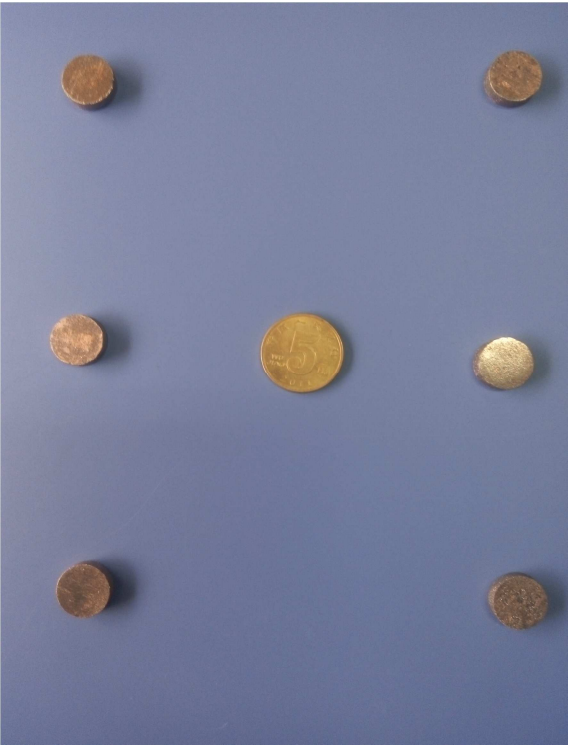
图2 无压浸渗法制备Diamond/Cu复合材料的宏观形貌。
