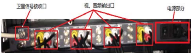
图4 卫星数字电视接收机线缆连接图。
