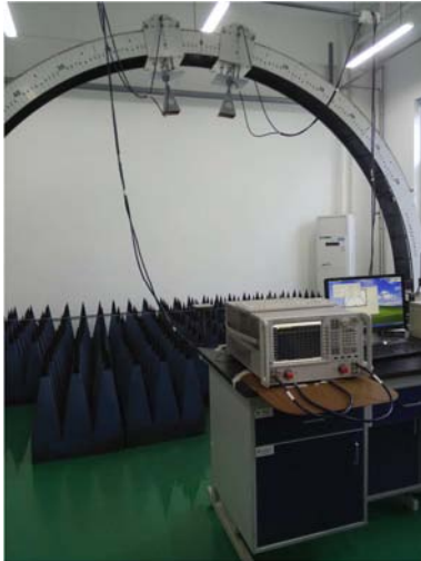
图8 吸波材料样品反射率测量图。
