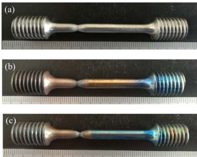
图8 不同温度焊接接头拉伸试样断裂照片：(a) 25℃, (b) 550℃, (c) 600℃。
