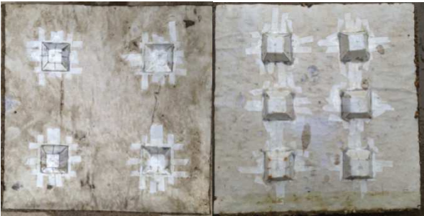
图2 一种新型板钉式路面砖底面。
