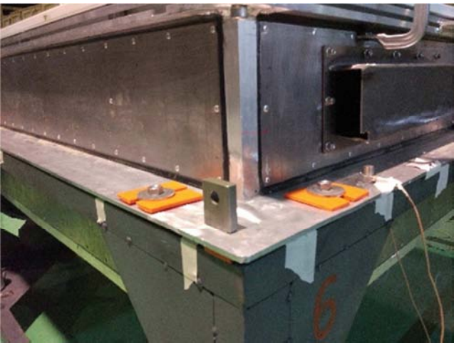
图5 减振泡棉安装图。
