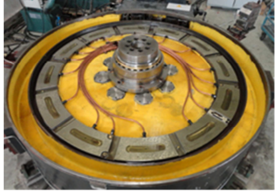
图2 CKS5235数控立式车床工作台静压导轨。
