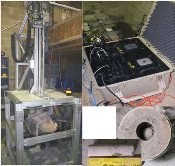
图10 CRUX钻取采样器及其控制箱。
