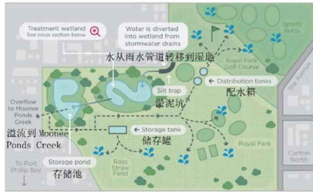
图3 雨水处理系统（图片来源：作者整理）。
