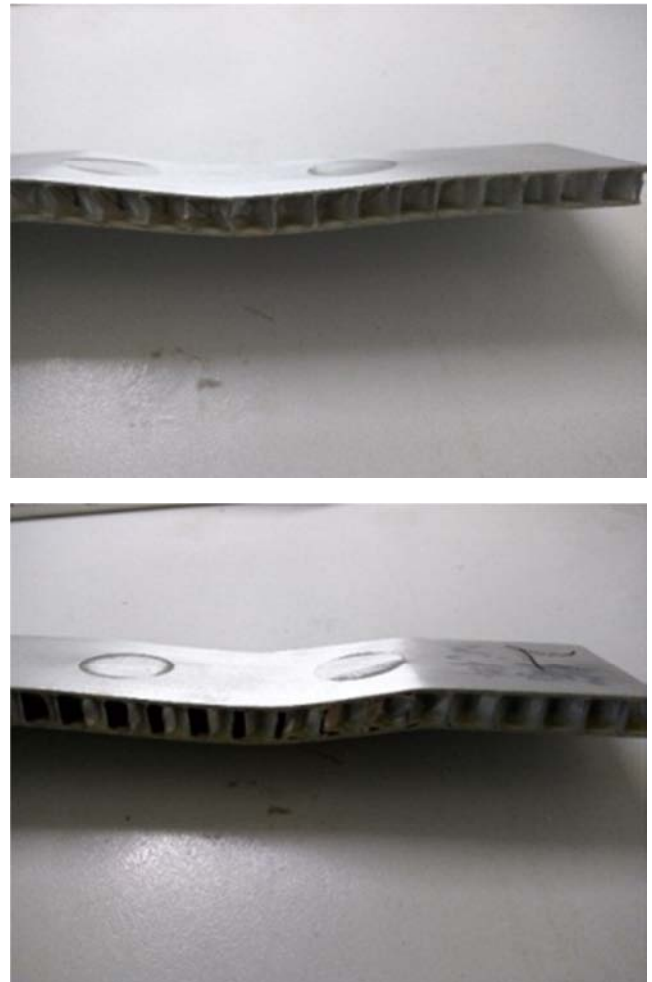
图6 三点弯曲试件失效结果照片。
