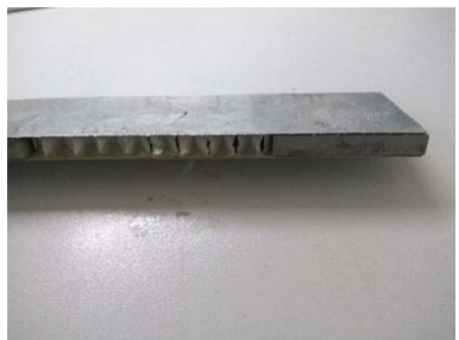
图2 面内拉伸试件失效结果照片。
