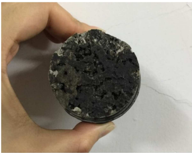
图2 60℃时粘结层破坏断面。
