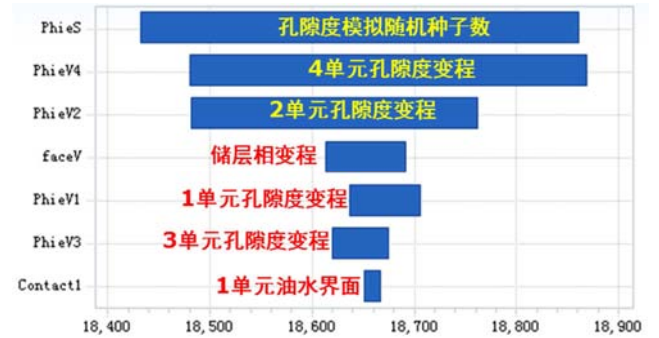
图6 地下原油体积影响因素龙卷风图（7个变量420次运算计算，千方）。
