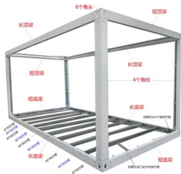
图8 打包箱房结构框架。
